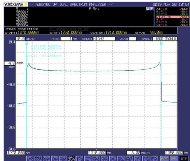
Spectre laser balayé à 1310nm.
